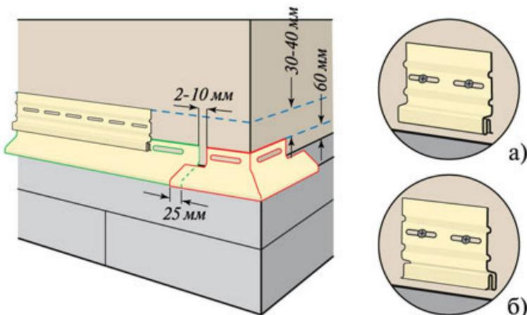
Установку отлива начинают с угла дома. Сначала изготавливается угловой элемент (как показано на рисунке), который крепится на углах дома. Последующие отливы устанавливаются с нахлестом рабочей поверхности = 25 мм.
