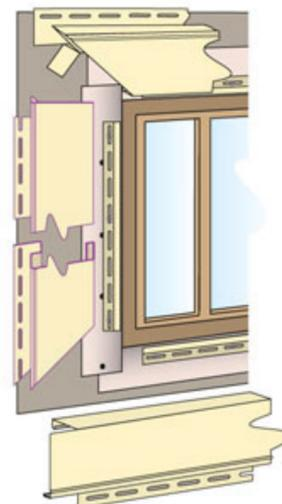
Наличник 89 мм Döcke. Заготавливаются отрезки стартового профиля и наличники на оконный проем. Перед установкой наличника по всему периметру окна устанавливаются отрезки стартового профиля. Длина всех элементов должна быть равной, соответственно, длине и высоте проема плюс две ширины используемых наличников. У верхнего наличника в изгибе с обеих сторон делаются надрезы длиной 20 мм, и получившиеся «язычки» отгибаются вниз, по ним вода с верхнего наличника будет отводиться за боковые.
