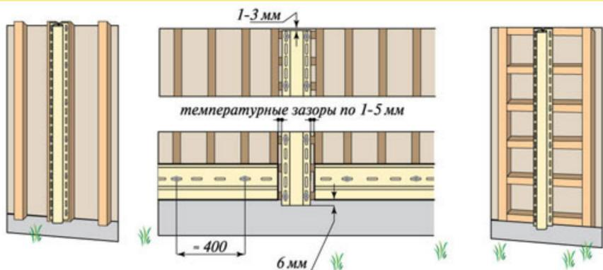
Н-профиль устанавливается по технологии внешнего и внутреннего угла. Для его монтажа нужно обязательно подготовить места крепления.
