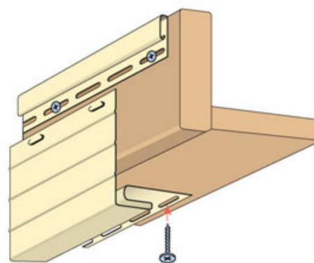
Горизонтальные J-фаски устанавливают по правилам крепления горизонтальных элементов, наклонные J-фаски крепят по правилам установки вертикальных элементов. К верхней кромке ветровой доски крепится финишный профиль. Фаска защелкивается в финишную планку на «зацепы». При необходимости удлинить J-фаску элементы закрепляются внахлест на величину 25 мм.
