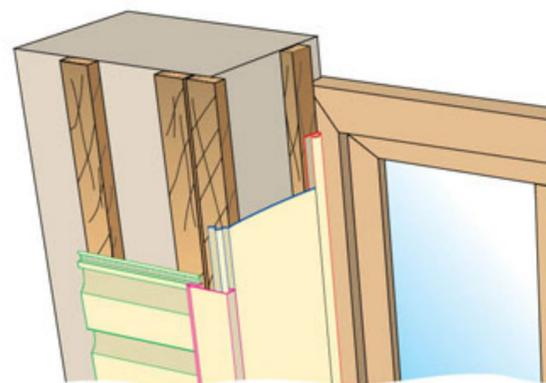
Монтаж происходит так же, как и в выше указанных случаях, только вначале монтируется финишный профиль, затем откос, и в завершение устанавливаем наличник.
