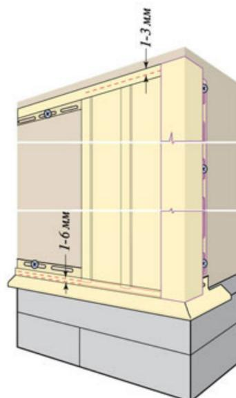
При монтаже вертикального сайдинга на цоколь дома вместо стартовой планки устанавливают отлив и/или окантовочный профиль, поверх устанавливается J-профиль, окантовочный профиль или молдинг. Крепится вертикальный сайдинг по аналогии с углами и H-профилем.
