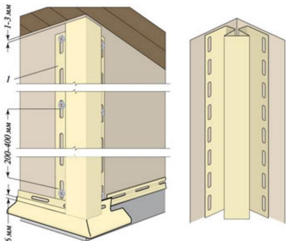
Внешние и внутренние углы устанавливаются на стыках стен так, чтобы их верхняя часть была на 1-3 мм ниже карниза или софита, а нижняя часть на 4-6 мм ниже стартового профиля.
