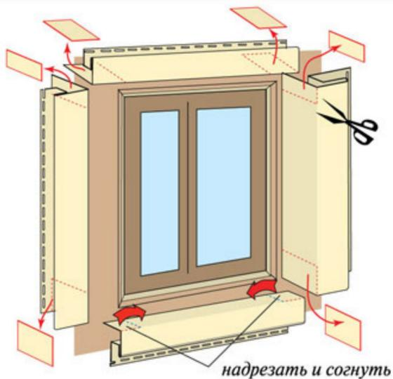
Технология монтажа такая же, как и у наличника. Разница заключается только в подрезке околооконного профиля и установке по периметру окна финишной планки.
