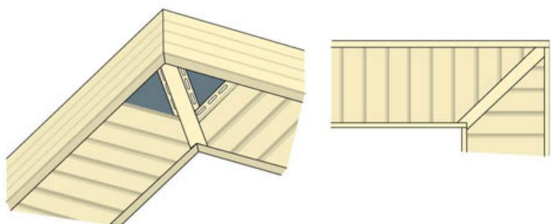
Софит устанавливается между молдингом и J-фаской. Технология монтажа соффита очень проста: отрезается панель нужного размера за вычетом зазора на установку. Один конец заводится в молдинг, другой в J-фаску и фиксируется саморезом. Следующий софит монтируется таким же образом и защелкивается в замок первого, и так далее.
